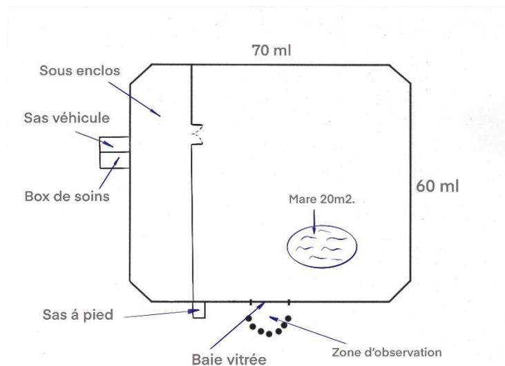
Les clôtures de cet enclos sont en grillage plastifié à simple torsion, mailles de 50 mm, de 3,7 m de haut, dont les cinquante premiers centimètres forment un retour enterré à 20 cm dans le sol. Sa hauteur à partir du sol est de 3 m. (cf. schéma suivant).
